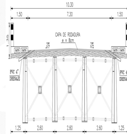
**Sistema simplemente apoyado, metálicas , tablero superior de 0,20 m de espesor, barandales y protecciones de hormigón armado**
