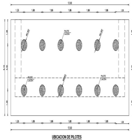
**Cimentación Profunda:** Pilotes pre barrenados de hormigón armado de 600m de diámetro y 6 m de profundidad
