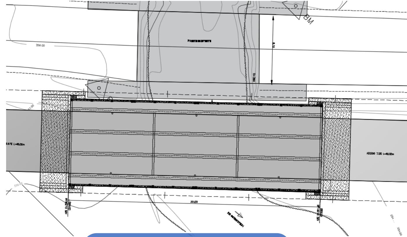
Los puentes nuevos han sido **IMPLANTADOS** aguas abajo del puente existente. El puente existente se utilizará como paso provisional mientras dure la construcción de la estructura definitiva.
